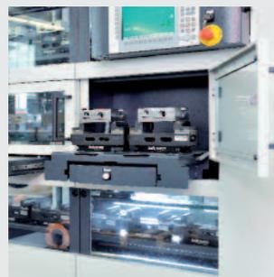
Ein- und Auslagerungsstation zum hauptzeitparallelen Bestücken
