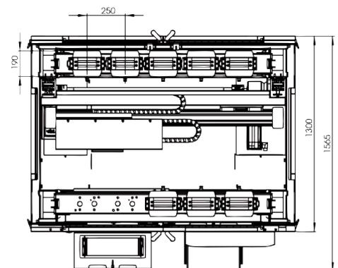
Die Indumatik® Light 30 ist ein geschlossener Automat zum Werkstückwechsel. Seitlich an der Werkzeugmaschine angeschlossen, ist dieser immer kurzfristig einsatzbereit. Ein kompaktes System, das die drei Themen Fräsen, Spannen und Automatisieren elegant miteinander verbindet.
