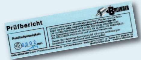
Prüftabelle „Rundlaufgenauigkeit“ am Beispiel Typ S, SG
