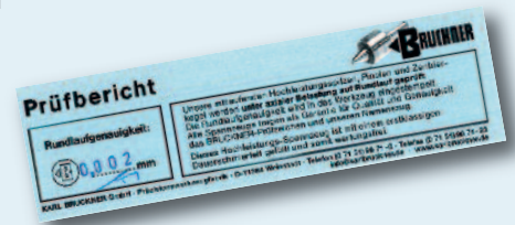
Prüftabelle „Rundlaufgenauigkeit“ am Beispiel Typ ZA, ZAG
